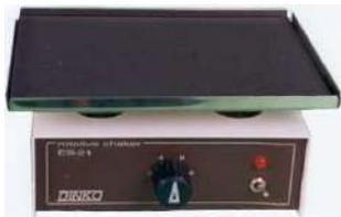
Velocidad regulable: 0 a 800 rpm. Amplitud orbital: 12 mm Ø.
