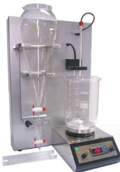
Dispositivo para reproducir el método de digestión artificial de carnes por enzimas proteolíticos en pH controlado con el fin de someter a análisis los residuos no digeridos
