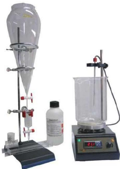
Para digestión de carnes según el método oficial para la extracción de triquinas.
