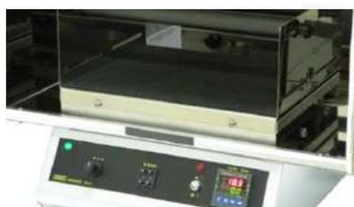
Detalle interior con la bandeja universal en U y dos rodillos de sujeción deslizables horizontalmente y en dos alturas distintas que permiten acomodar diversos utensilios como frascos, matraces, vasos, etc.
