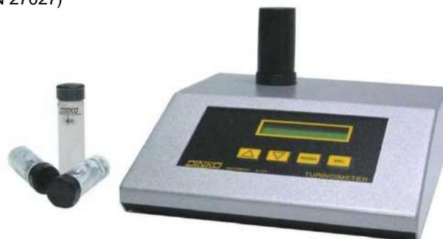
Para paliar la influencia de la luz difusa, el color de la muestra y la diferencia entre los ángulos de reflexión según el tamaño de las partículas se utilizan sensores cubriendo 360° alrededor del tubo de muestras. Las señales obtenidas se promedian automáticamente y se ofrecen lecturas de turbidez RATIO en unidades NTU.
