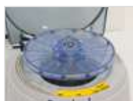
Cabezal microhematocrito para 12 tubos
