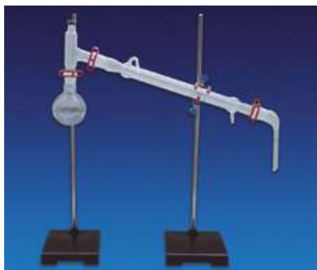
1 | Fabricado en vidrio borosilicato con uniones esmeriladas 29/32.
