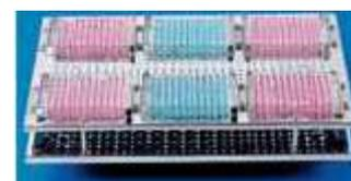
**Soporte** para 58 pocillos de reacción de 1,5-2,0 ml, con protección antiflotación.
